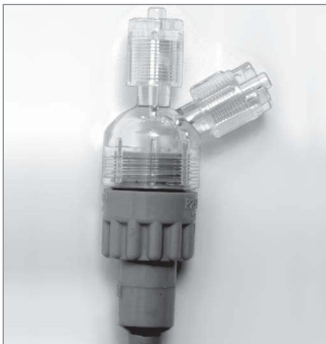
Figura 9.5. Transductor de presión de cúpula.
