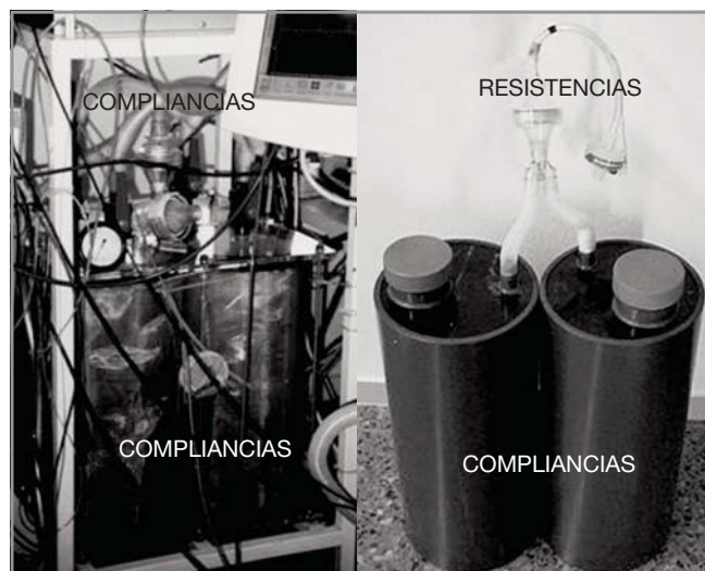
Figura 21.4. Modelos de impedancias por el simulador de pulmón.
