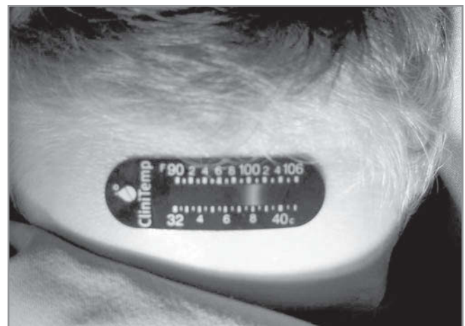
Figura 37.3. Indicador de tendencia de la temperatura fabricado en cristal líquido. Se coloca mediante un adhesivo sobre la piel de la frente.
