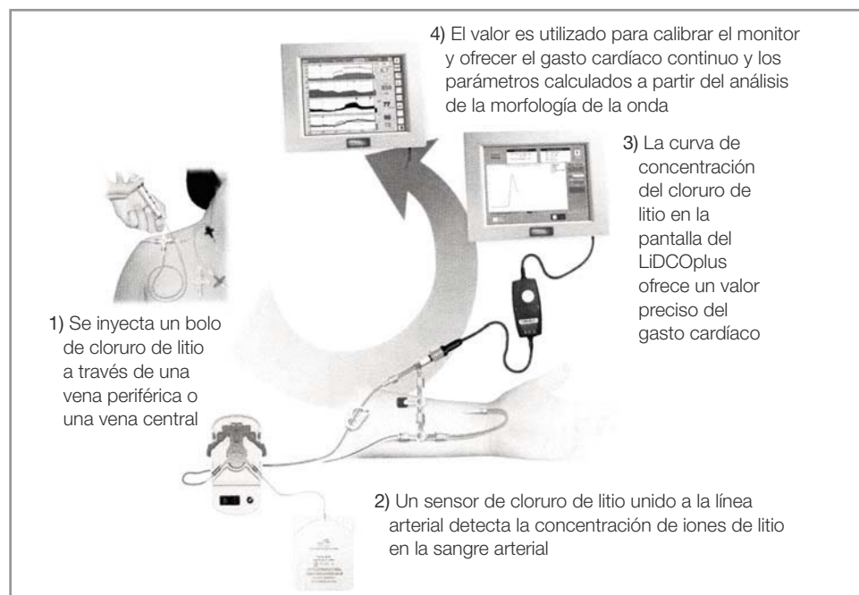
Figura 14.4. Técnica de análisis del gasto cardíaco de la máquina LiDCOplus.
