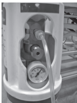
FIGURAS 3 Y 4. Caudalímetro adaptado en la bala de gas tras el manorreductor.
