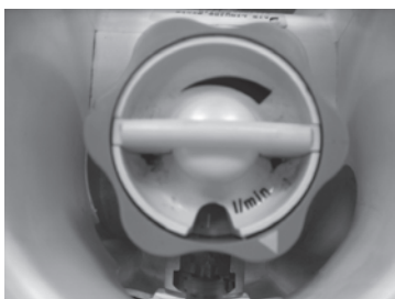
FIGURAS 3 Y 4. Caudalímetro adaptado en la bala de gas tras el manorreductor.
